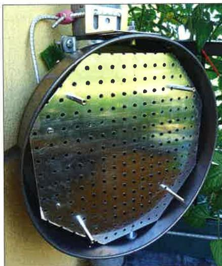
**Bild 1:** Als Gehäuse für die IR-Bake dient eine Kuchenbackform. Die Infrarot-LEDs sind in den erweiterten Bohrungen zweier übereinander liegender Lochbleche befestigt. Die Winkel oben und unten ermöglichen das Drehen und Kippen.
